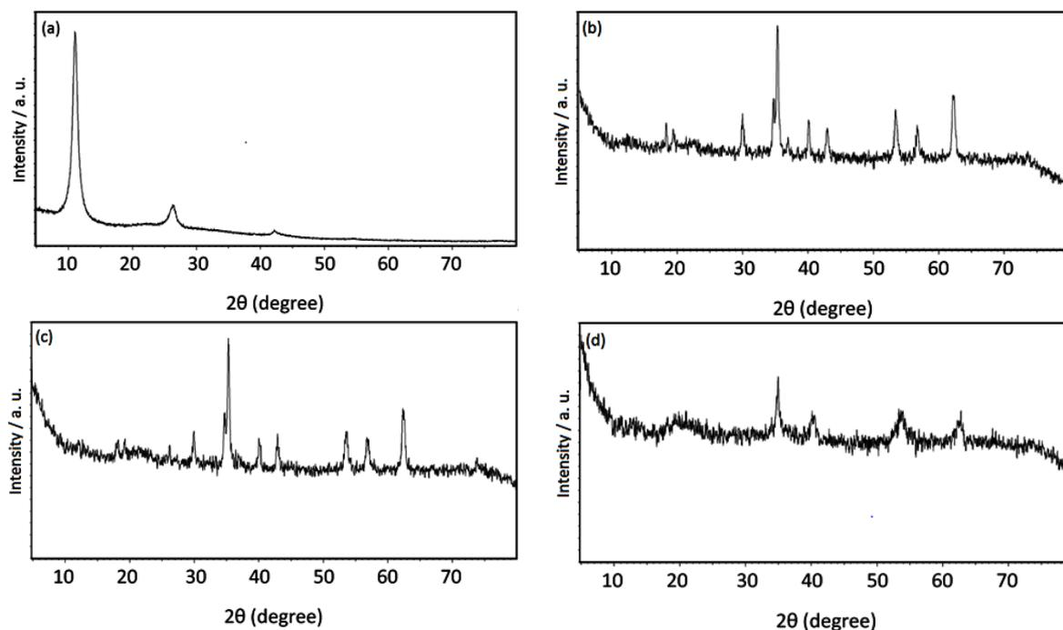
**Figure 3.** XRD spectrum of (a) GO, (b) FeCo/C 2:1, (c) FeCo/CNT and (d) FeCo/rGO 2:1.
